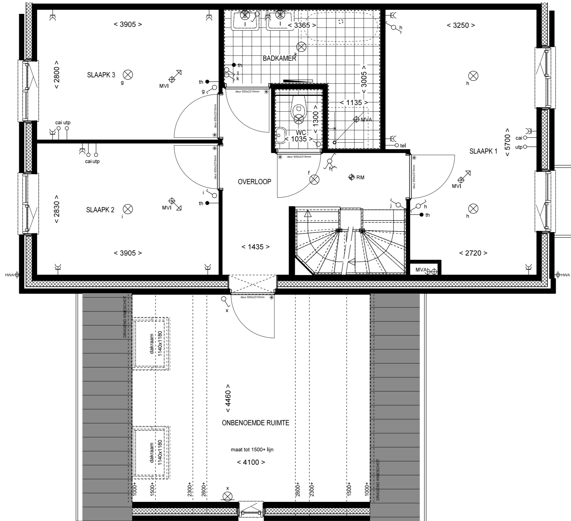
1e VERDIEPING OPTIE: DAKVENSTER 1140x1180mm ACHTERZIJDE R 10.30.02
