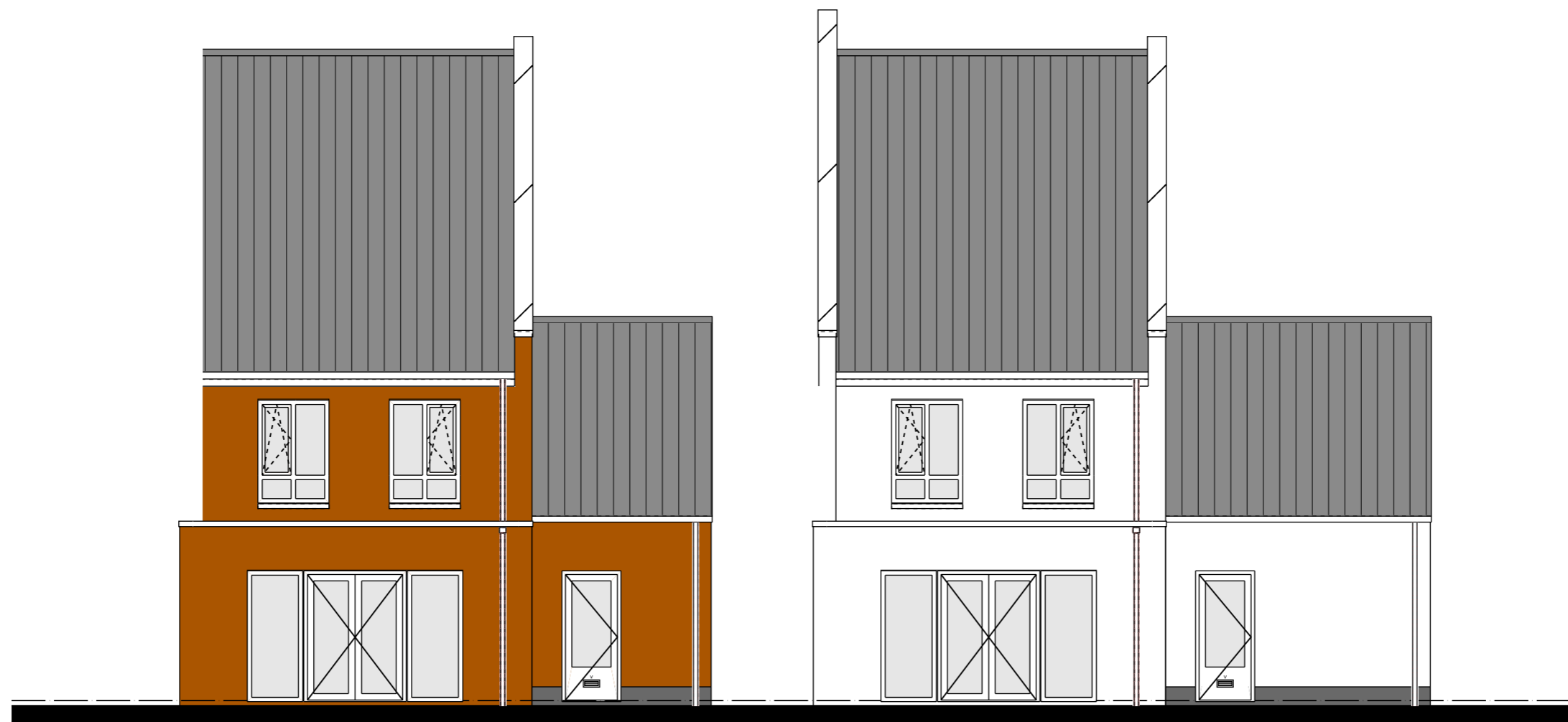
ACHTERGEVEL OPTIE: UITBOUW 1200/2400mm UITBOUW VAN 2400mm
